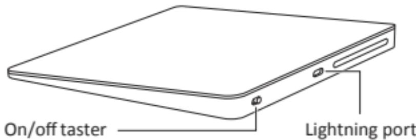
Koristite Lightning na USB kabl koji ste dobili uz trackpad. Priključite Lightning kraj kabla u Lightning port na Vašem trackpad-u, a USB kraj kabla u USB port na Vašem Mac-u. Kliznite prekidač trackpad-a za on/off switch na "on" (tako da vidite zleeno na prekidaču).
